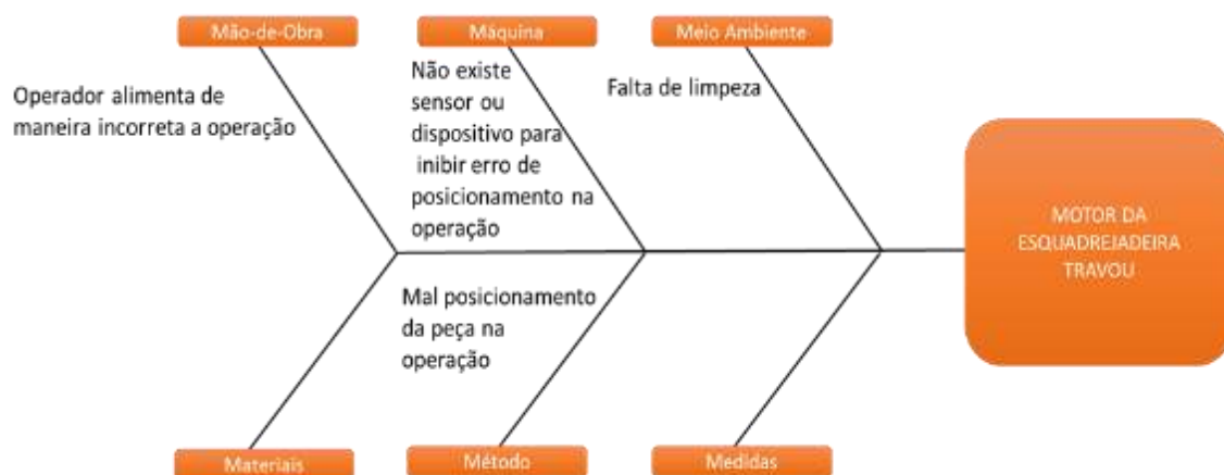
Figura 7. Diagrama de Causa e Efeito para motor travado
