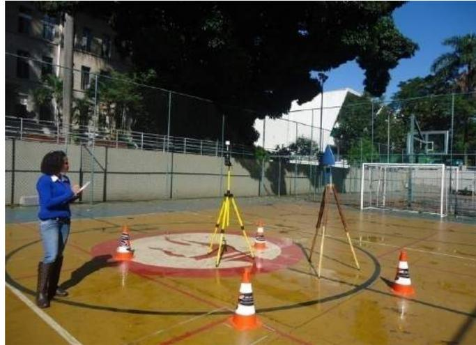
**Figura 2** - Medição dos CEM's realizada na quadra principal
